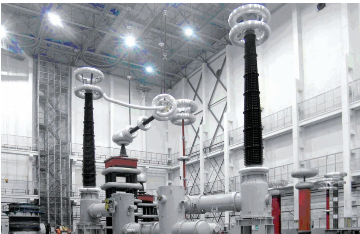
图6 西开生产的1100kV气体绝缘金属封闭开关设备（DS、ES、母线、出线套管）试验场景
