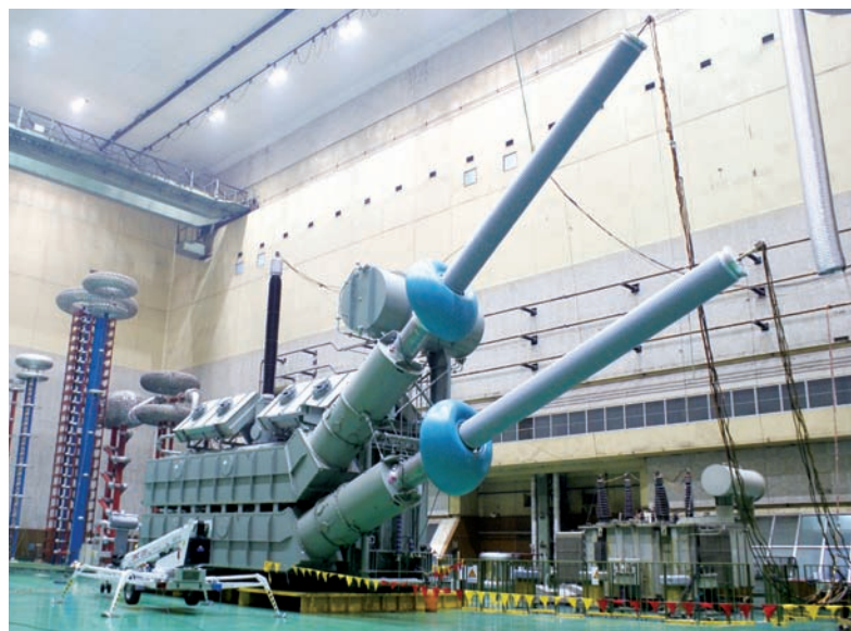
图8 西变公司生产的云南—广东 \pm 800 kV特高压直流输电示范工程换流变压器
