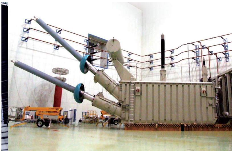
图12 西变公司生产的向家坝—上海±800 kV特高压直流输电示范工程换流变压器
